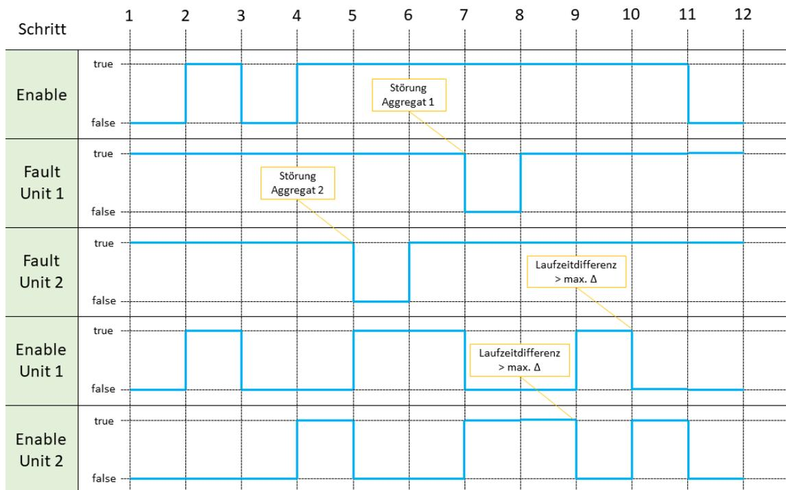
Hat ein laufendes Aggregat eine Störung, so übernimmt das zweite Aggregat, unabhängig von seiner Laufzeit. Hat ein nicht laufendes Aggregat eine Störung, so wird die Laufzeitumschaltung nicht durchgeführt, auch wenn die Bedingungen dafür erreicht wären. Haben beide Aggregate eine Störung, so wird der Ausgang Total Failure auf true gesetzt.
