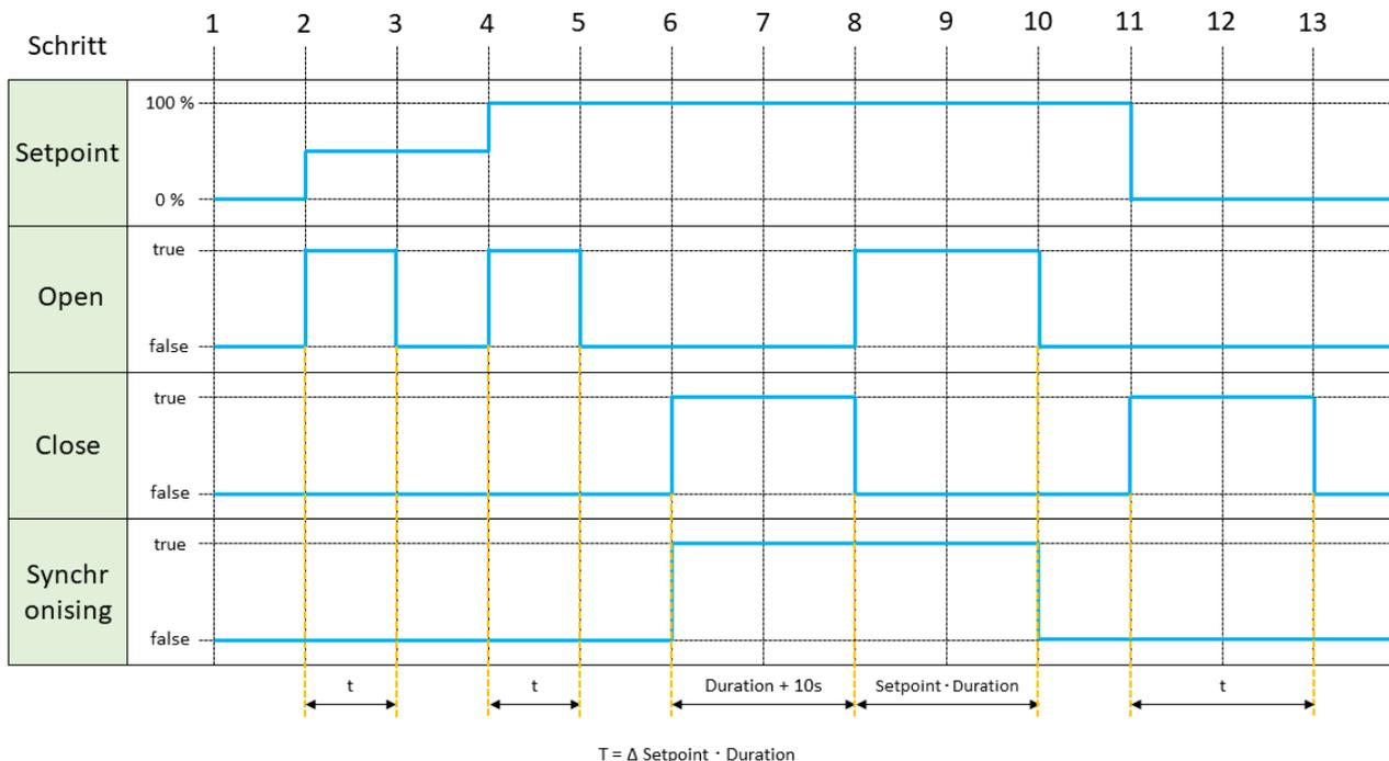
Wird die Synchronisation eingeschaltet, wird im Intervall der Synchronisation der Antrieb voll geschlossen (+10s Sicherheit) und dann wieder gemäss dem Setpoint aufgefahen. Dies wird dazu genutzt, um die sich im Laufe der Zeit summierende Ungenauigkeit auszugleichen.
