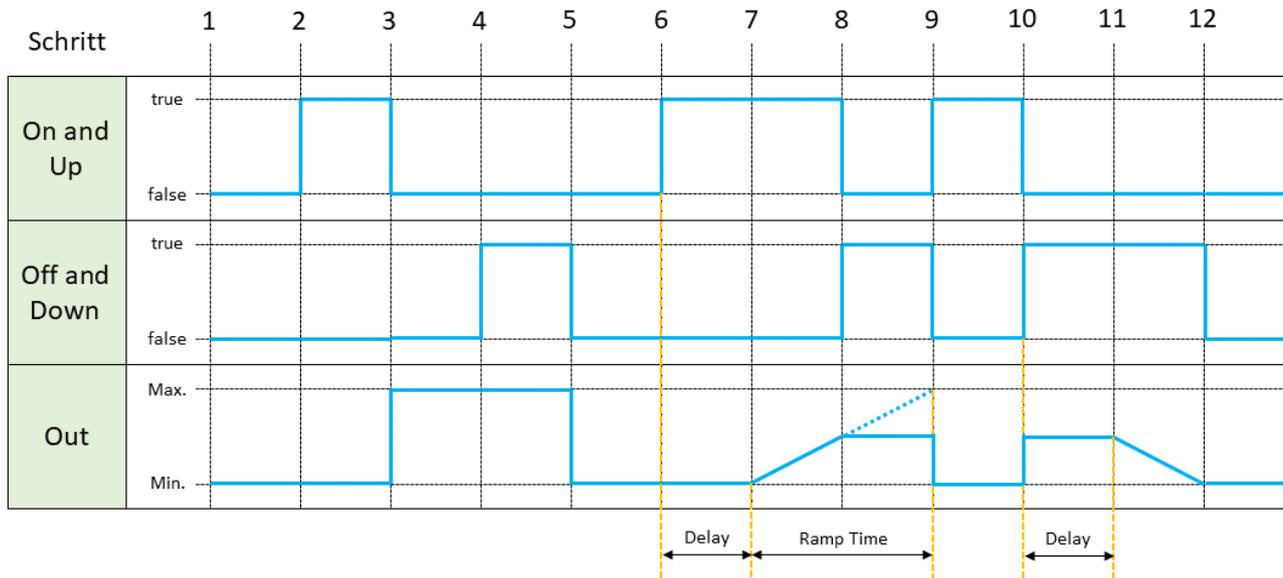
Aufgepasst: Das Erkennen eines digitalen Eingangs unter 300ms ist mit Niagara schwierig, da alle Eingänge über Busprotokolle mit unterschiedlicher Geschwindigkeit eingelesen werden. Aus diesem Grund ist bei der Bewertung der Funktion des Dimmers gewisse Vorsicht geboten.
